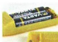
**Batteriewechsel:** Der Mini-Schmelzer wird mit zwei Mignonzellen Batterien LR6/AA/1,5V geliefert. Um die Batterien zu wechseln wird das
